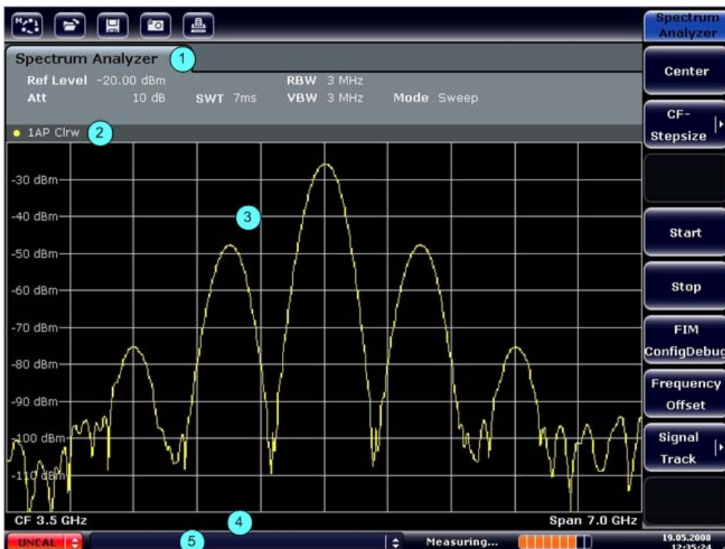
Abbildung 4-1: Bildschirmaufteilung des R&S FSV im Analysatorbetrieb
