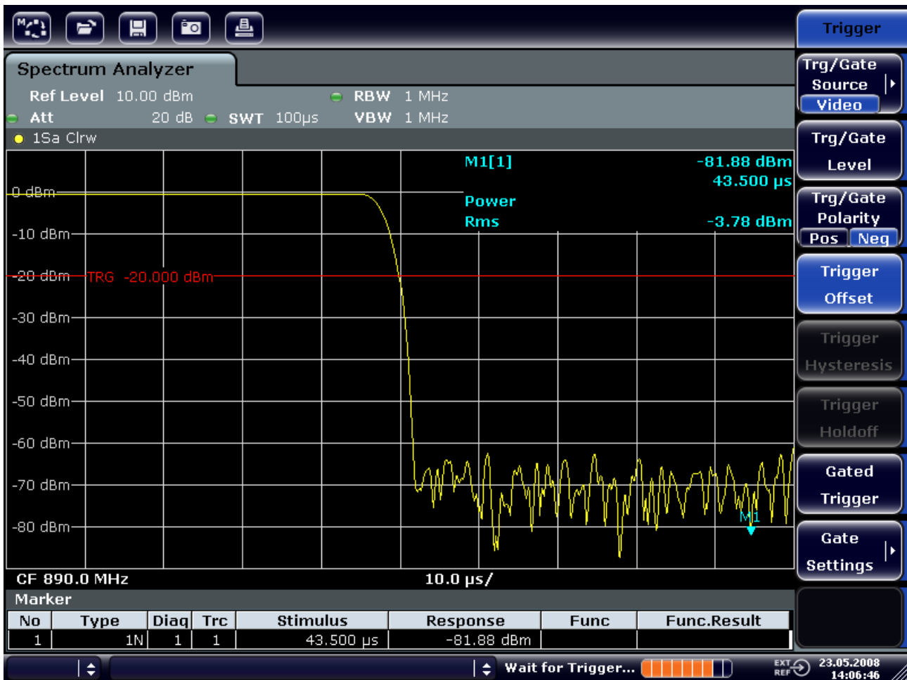
Abbildung 5-11: Abfallende Flanke des GSM-Bursts mit hoher Zeitauflösung dargestellt
